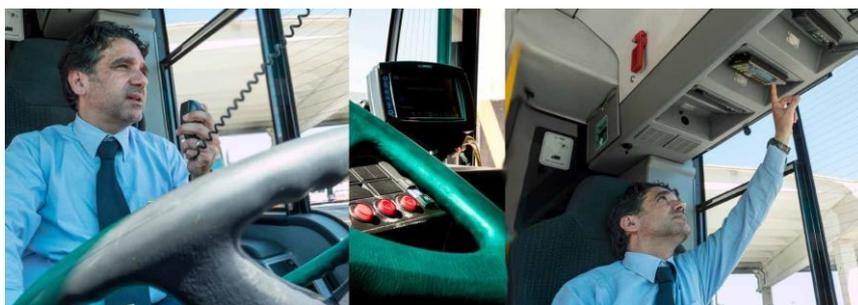
Inoltre, ciascun veicolo è collegato all'Azienda mediante il sistema Automatic Vehicle Monitoring (AVM) che garantisce il controllo centralizzato della flotta e del servizio e con il quale l'autista si interfaccia attraverso l'apposito apparato posizionato presso il cruscotto del veicolo.
